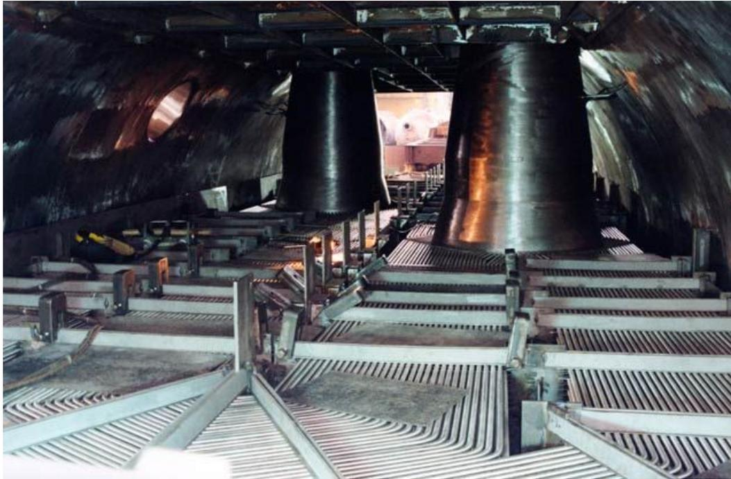
Трубы поставляются на завод-изготовитель ПГ длиной до 16 м, что позволяет изготавливать змеевики без сварных стыков.
