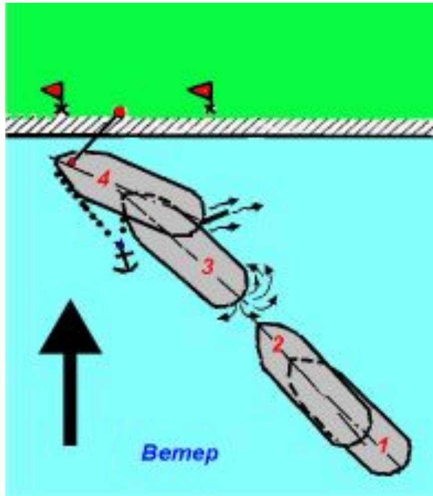
Швартовка судна при прижимном ветре
