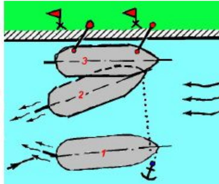
Швартовка судна против течения с отдачей якоря
