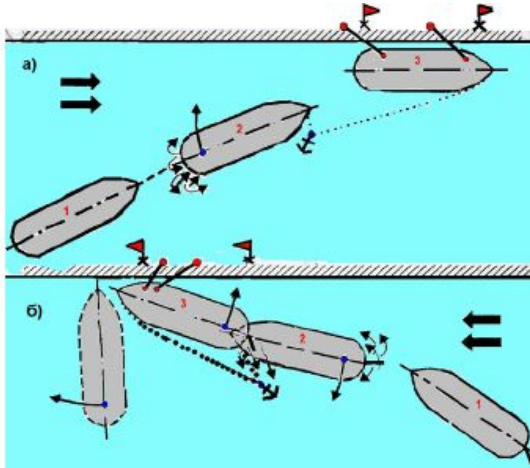
Швартовка судна бортом к причалу по ветру, дующему вдоль причала
