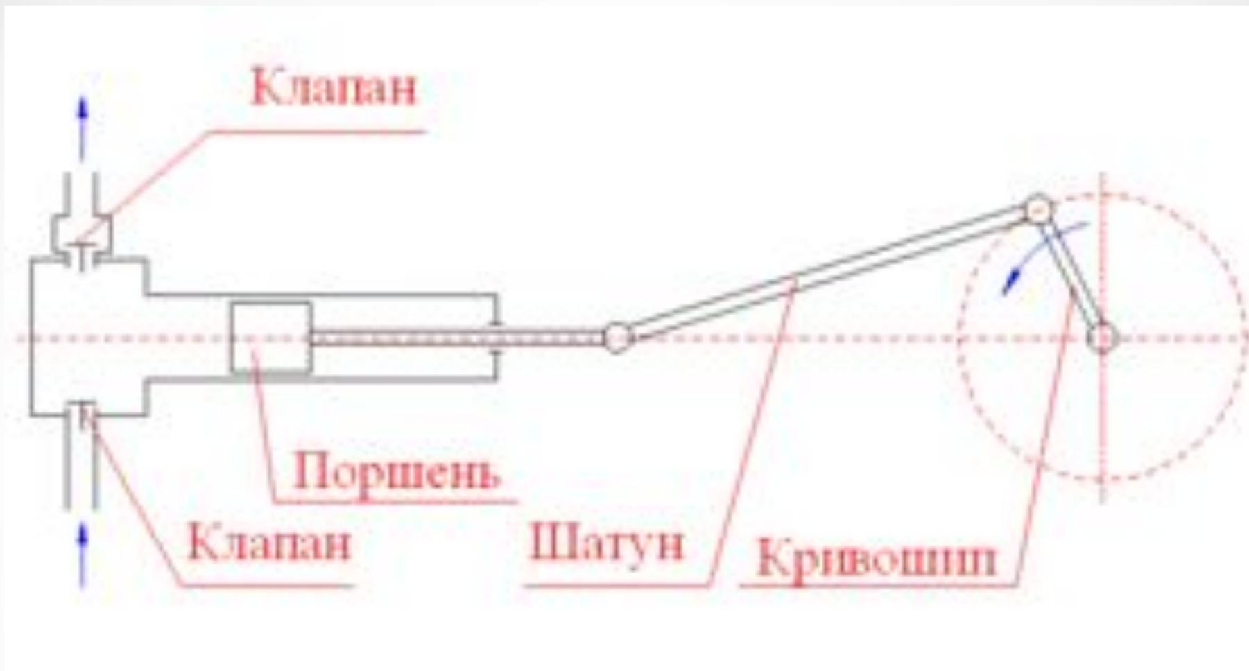
При движении поршня вправо в рабочей камере насоса создаётся разрежение, нижний клапан открыт, а верхний клапан закрыт, — происходит всасывание жидкости. При движении в обратном направлении в рабочей камере создаётся избыточное давление, и уже открыт верхний клапан, а нижний закрыт, — происходит нагнетание жидкости.
