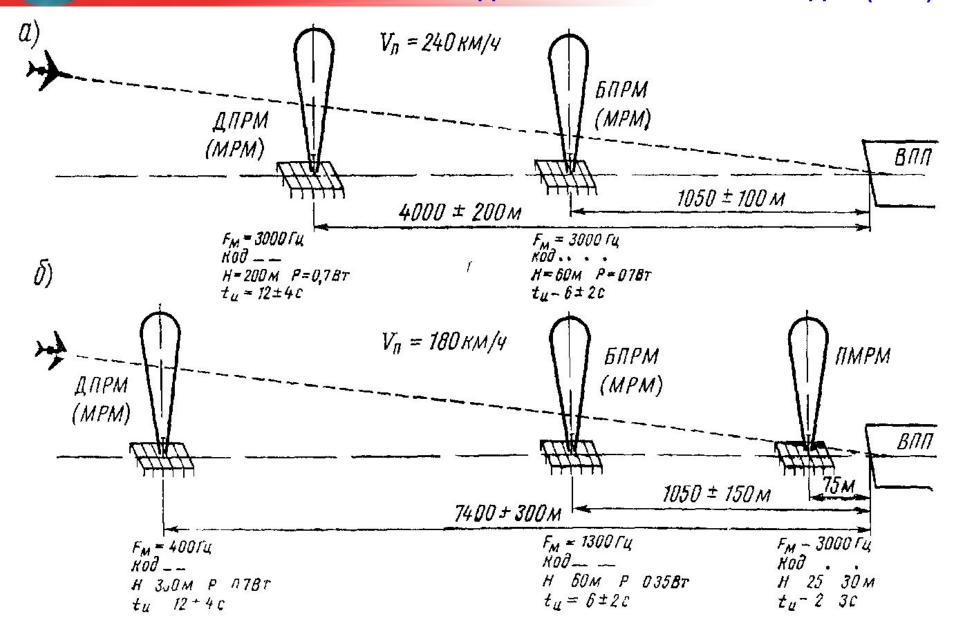
**Радионавигационное обеспечение транспортных средств ХАРАКТЕРИСТИКА ОБОРУДОВАНИЯ СИСТЕМЫ ПОСАДКИ (ОСП)**
