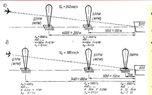
Дальняя приводная радиостанция (ДПРС) совместно с АРК используется для привода ВС в район аэродрома, выполнения предпосадочного маневра и выдерживания линии посадочного курса самолета на траектории посадки.
