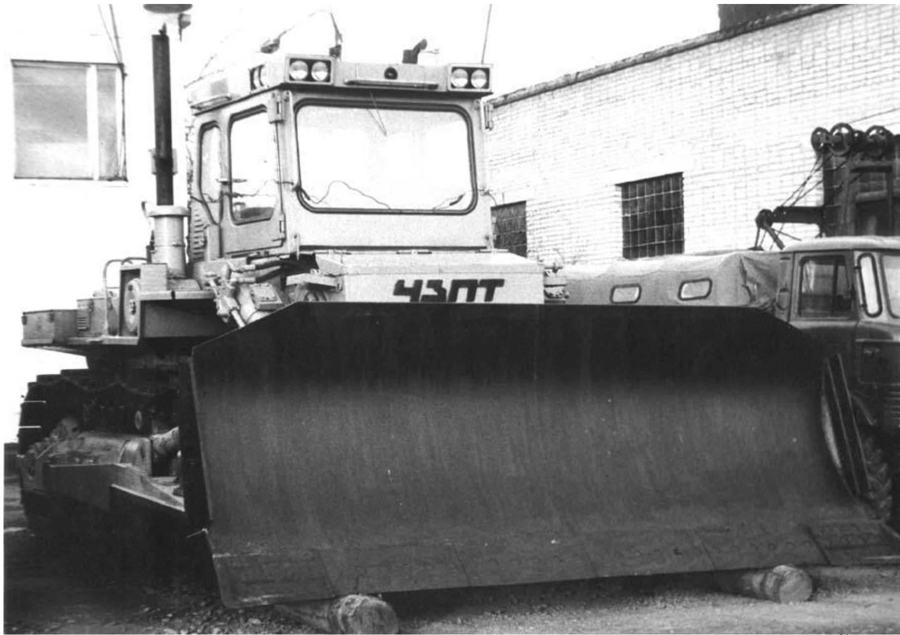
Бульдозер ДЗ-59 на базовом тракторе Т-330
