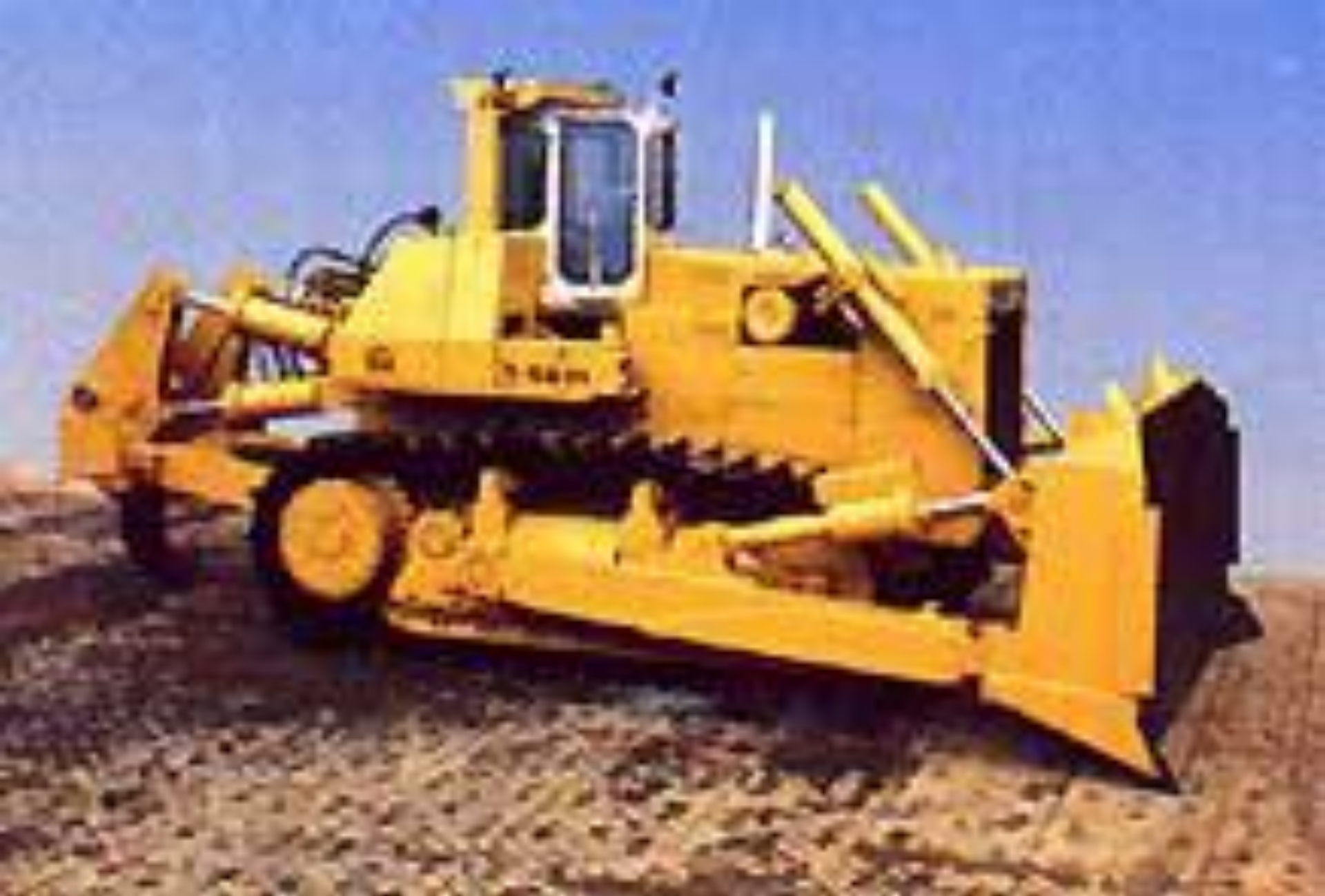
Бульдозерное и рыхлительное оборудование на Т 3 -500
