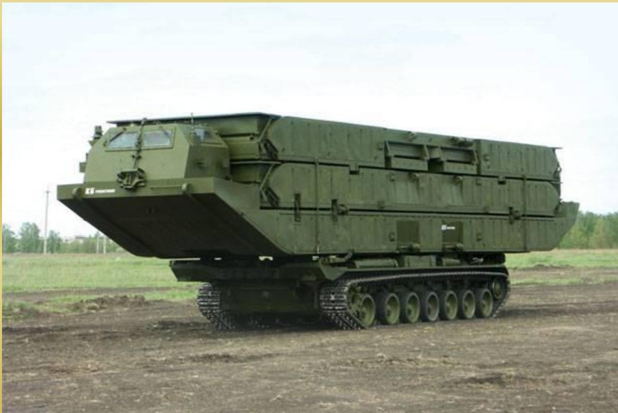
В сложенном виде паром общим весом **29,5 тонн** укладывается в поперечные габариты транспортера. В разложенном - паром имеет длину 16,5 метра и ширину 10,3 м. Находясь на воде, ПДП может принять на борт груз общим весом **до 60 тонн**.
