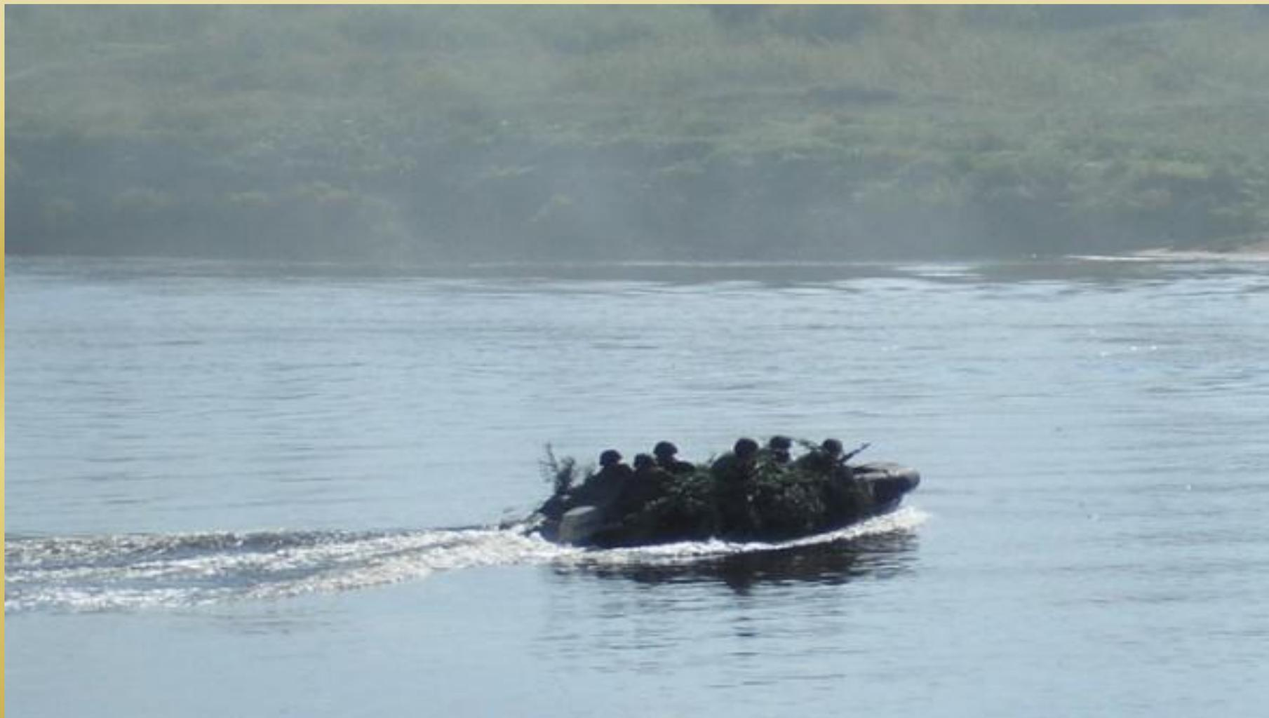
**Десантные лодки** предназначены для переправы личного состава мотострелковых частей (подразделений). Они бывают **надувными** (из прорезиненного материала на капроновой основе, на 8 и на 30 человек) и **складными из бакелизированной фанеры**.
