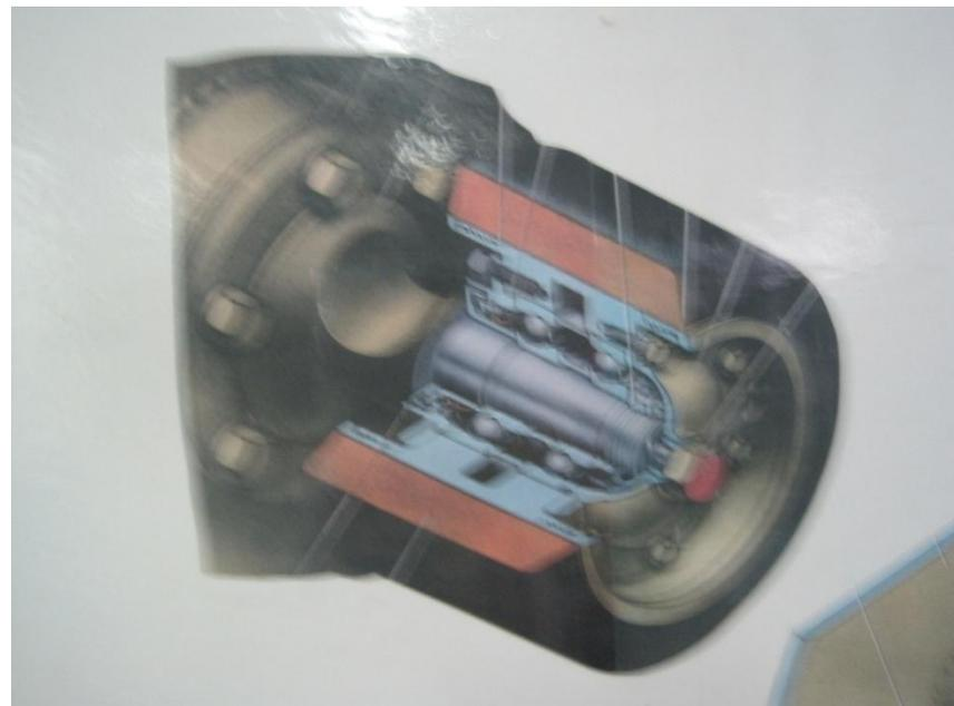
Ступица катка изготовлена из алюминиевого сплава. В месте контакта с гребнями гусеницы в ступицу катка с обеих сторон ввернуты стальные гайки.
