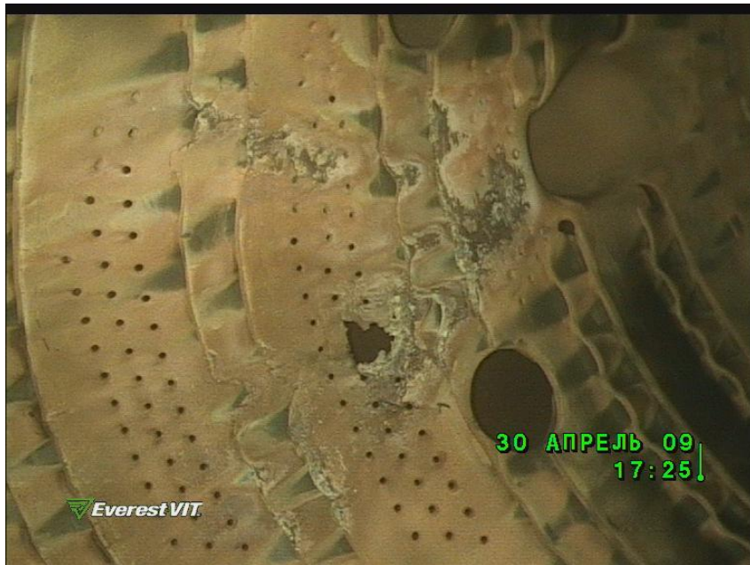
Рис. Двигатель ПС-90А; обгорание кромок секции, прогар секции, трещина
