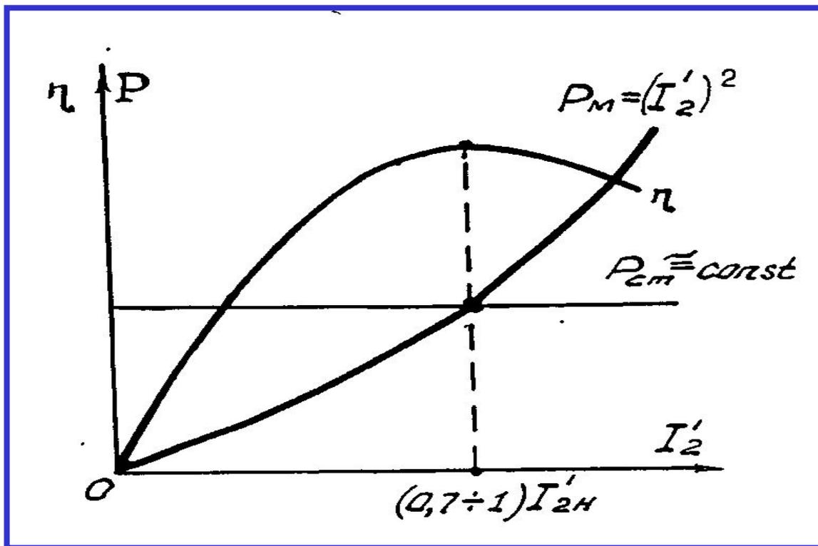
Максимум КПД соответствует такой нагрузке, при которой переменные потери - потери в меди обмоток - равны постоянным потерям - потерям в стали, т.е.  $p_m = p_{ст}$
