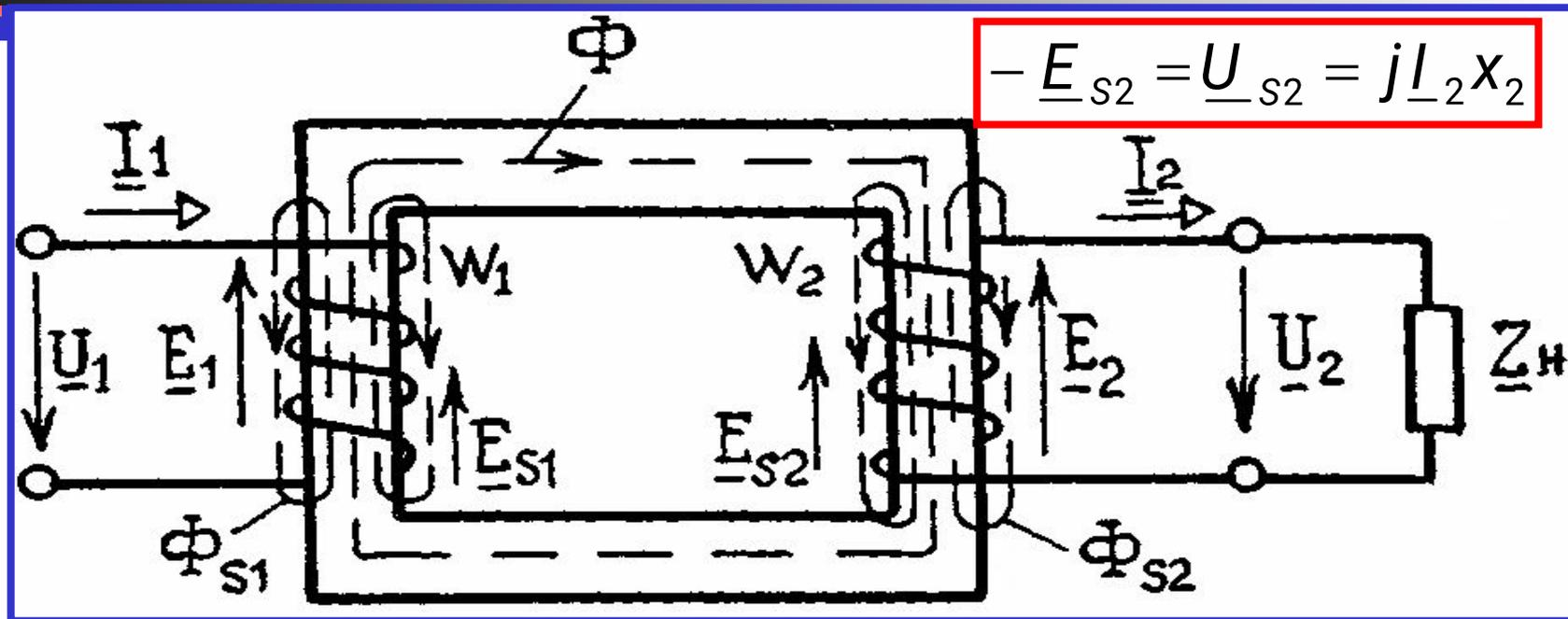
Замена ЭДС  $\underline{E}_{S1}$  и  $\underline{E}_{S2}$  падениями напряжения  $\underline{U}_{S1} = j\dot{I}_1 X_1$  и  $\underline{U}_{S2} = j\dot{I}_2 X_2$ , делает более наглядной роль потоков рассеяния  $\Phi_{S1}$  и  $\Phi_{S2}$ : они создают индуктивные падения напряжения в обмотках, не участвуя в передаче энергии из одной обмотки в другую.
