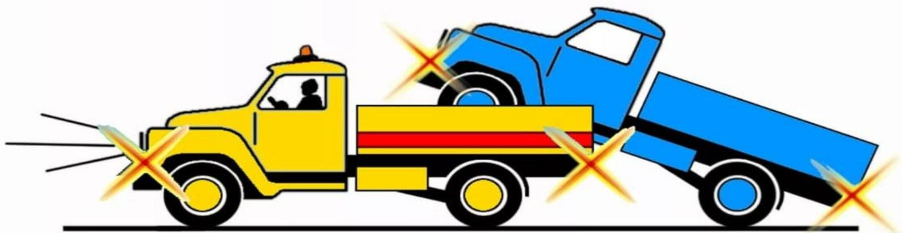
Буксировка методом частичной погрузки
