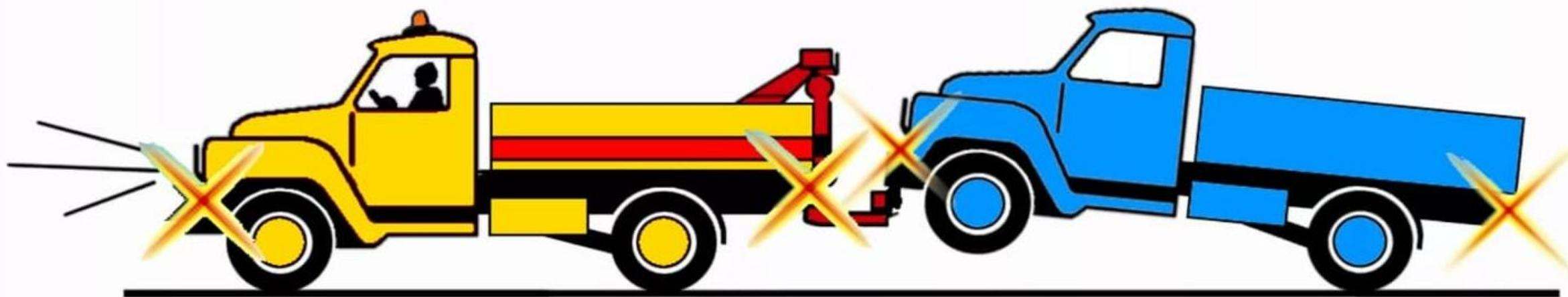
Буксировка методом частичной погрузки
