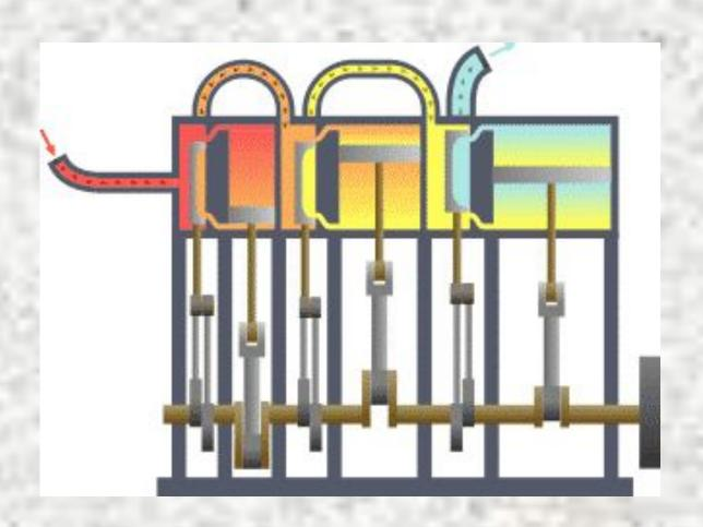
Паровая машина — тепловой двигатель внешнего сгорания, преобразующий энергию нагретого пара в механическую работу возвратно-поступательного движения поршня или вращательного движения вала.
