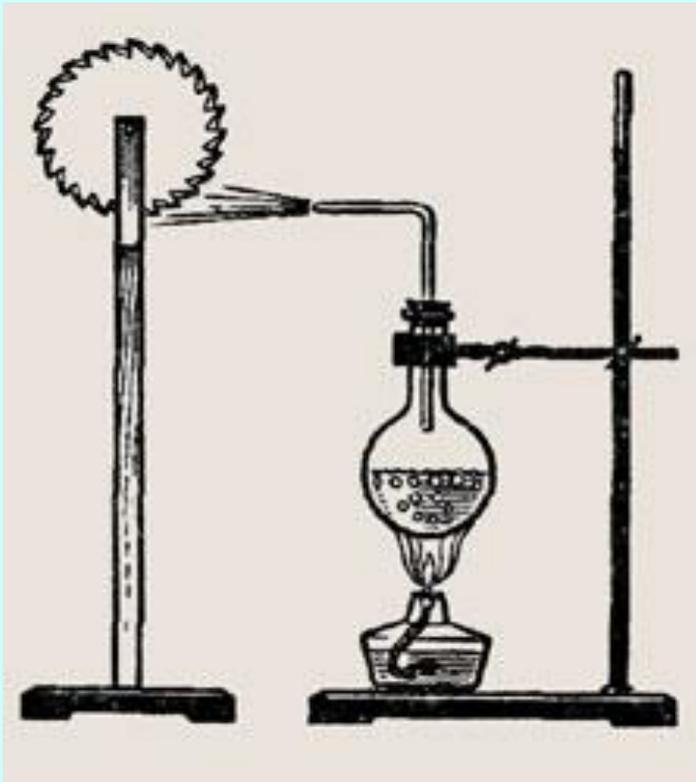
Пар или нагретый до высокой температуры газ вращает вал двигателя без помощи поршня, шатуна и коленчатого вала.
