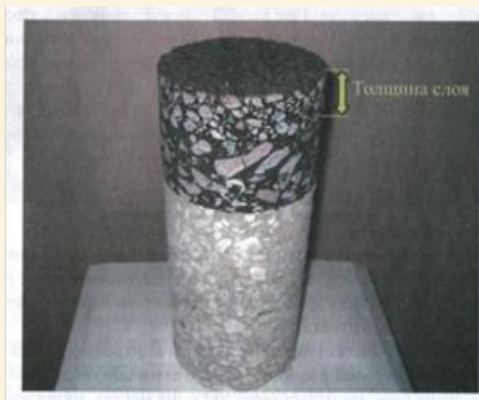
Рис. Определение толщины слоя ЦМА в керне
