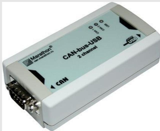
2-х каналный CAN-контроллера соответствующий спецификации CAN 2.0B; использует интерфейс, соответствующий спецификации USB 2.0 High Speed; первичная обработка кадров CAN-сети выполняется встроенным 32-х разрядным микроконтроллером ARM; CAN-bus интерфейс (в соответствии с CiA DS-102) с гальванической развязкой 1000 Вольт, защитой от перенапряжений и импульсных помех; Питание от шины USB; потребляемый ток - не более 200 мА; габариты 107\*53\*28 мм; диапазон рабочих температур: 0..+70 С
