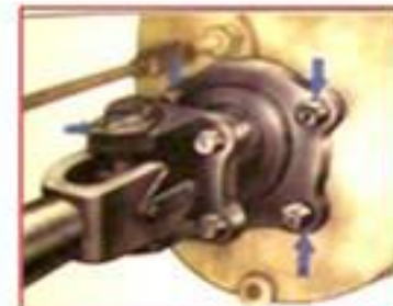
Проверка крепления фланцев и промежуточной опоры
