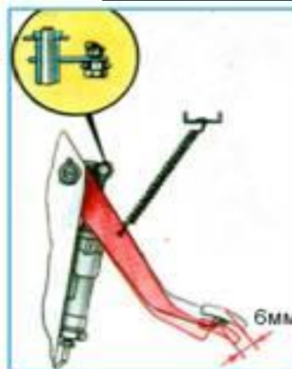
Регулировка свободного хода толкателя главного цилиндра
