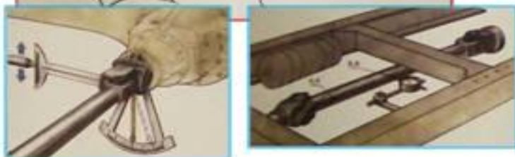
Проверка зазоров и биение карданного вала
