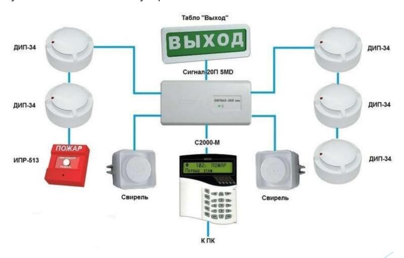
**Пожарные извещатели** - техническое средство, предназначенное для формирования сигнала о <u>пожаре</u>
