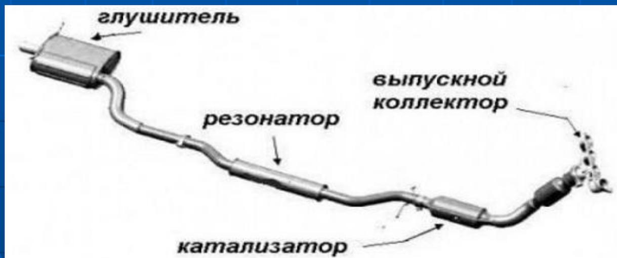
Принцип работы выпускной системы сводится к следующему. Выхлопные газы при открытии выпускного клапана с силой вырываются в выпускной коллектор.
