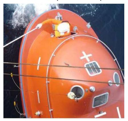
В носовой и кормовой частях на верхней части закрытия наклеивают кресты из светоотражающего материала (рис).
