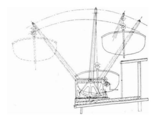
**Заваливающиеся шлюпбалки** также парные, но вращение их производится на шарнире у пятки. К такому типу шлюпбалок относят секторную шлюпбалку (рис), у которой по зубчатой рейке, закрепленной на палубе судна, катится зубчатый сектор благодаря вращению рукоятки винтового стержня, проходящего через нарезную обойму.
