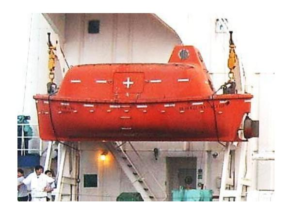
**Спасательная шлюпка** — это шлюпка, способная обеспечить сохранение жизни людей, терпящих бедствие, с момента оставления ими судна. Именно это назначение и определяет все требования, предъявляемые к конструкции и снабжению спасательных шлюпок (рис).
