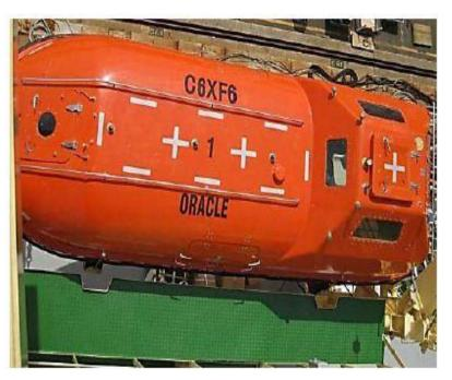
Шлюпка должна быть либо самоосушающейся, либо иметь ручной насос для удаления воды
