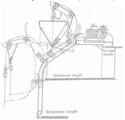
Один из типов показан на рис. Спуск шлюпки производится под действием ее собственного веса при ослаблении тормозного устройства шлюпочных лебедок. Преимущество этой группы шлюпбалок состоит в том, что при их применении нельзя повредить и смыть шлюпки, так как они хранятся над самой высокорасположенной палубой судна и далеко от борта.
