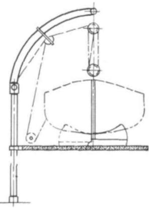
**Поворотные (обыкновенные) шлюпбалки** (рис.) состоят из стальных изогнутых балок, вращающихся вокруг своей продольной оси.
