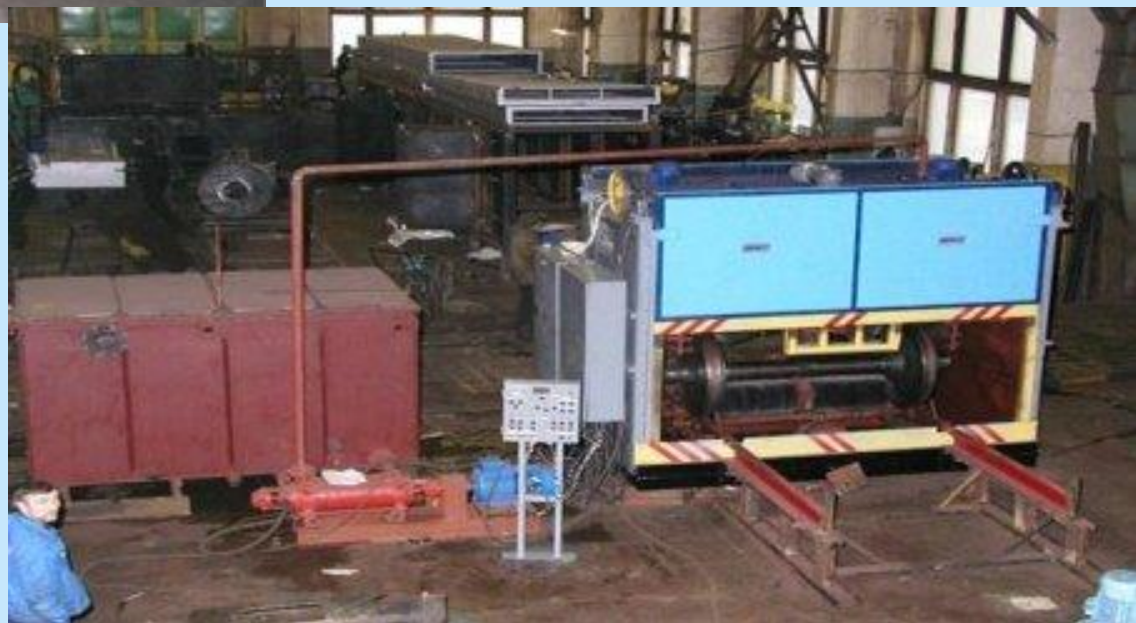
Общий вид автоматизированного комплекса для очистки колесных пар
