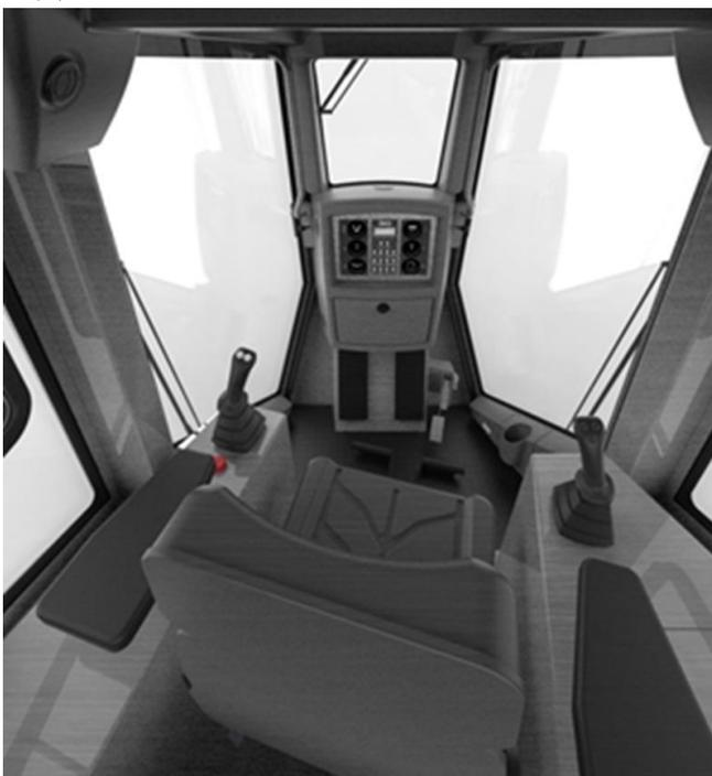
Комфортная кабина с низким уровнем шума и вибрации гарантирует высокую производительность труда. Управление машиной и оборудованием осуществляется гидро-серво джойстиком.
