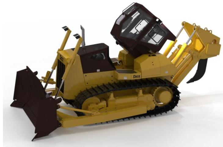
**Кабина повышенного комфорта.** Данная кабина оснащена в базовой комплектации кондиционером, улучшенной шумо и вибро изоляцией. Для проведения ТО и ремонта кабина откидывается гидравлическим подъемником на 45°
