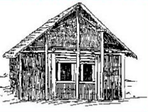
Зимний каркасный дом с плетеными стенами
