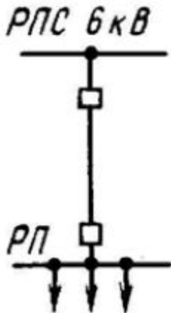
ОГР с небольшими электрическими нагрузками, не имеющие потребителей I и II категорий по надежности электроснабжения и расположенные на незначительном расстоянии от районной подстанции (РПС), питаются от шин 6 кВ РПС по одной кабельной (КЛ-6) или воздушной (ВЛ-6) линии электропередачи (рис. а).
