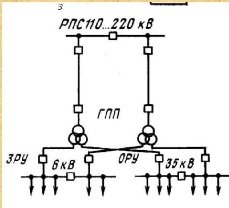
В последние годы для электроснабжения крупных ОГР с большой территорией горных работ, где на добычных и вскрышных работах используются сверхмощные одноковшовые экскаваторы и техника непрерывного действия, нашла применение схема, показанная на рис.4. и.
