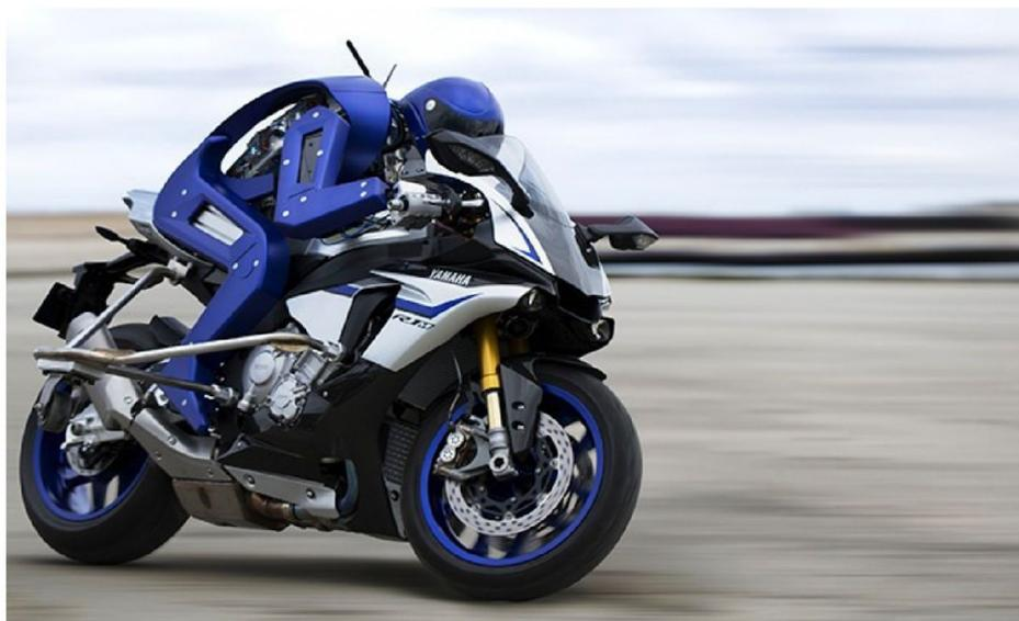
Концепт автономного робота-гуманоида для езды на мотоцикле. В планах создать робота способного управлять мотоциклом на треке на скорости более 200 км / ч .
