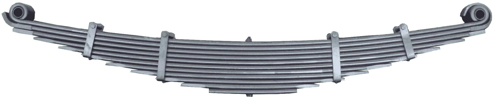
Листы рессор, требующие ремонта, отжигают в печи, после чего им придают требуемую стрелу пробега. Затем рессорные листы термически обрабатывают и рихтуют. Готовые рессорные листы поступают на посты сборки рессор. Некоторое количество поломанных рессорных листов используют для изготовления из них листов меньшей длины
