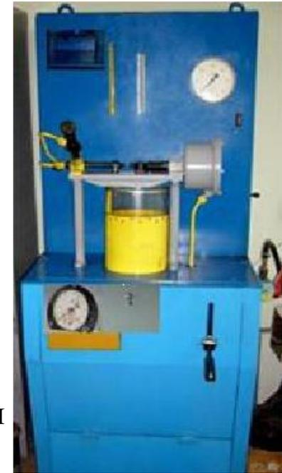
Стенд для испытания форсунок
