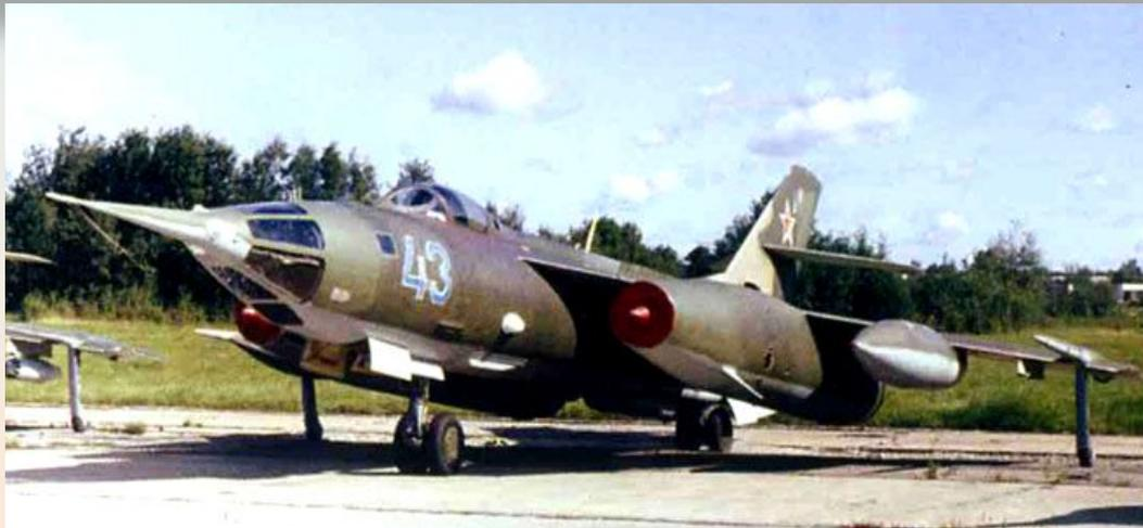
Самолет с таким шасси имеет плохую поперечную устойчивость, так как стойки не разнесены по размаху крыла, а большая нагрузка на переднюю стойку (40 — 50 % веса самолета) приводит к плохой проходимости как по грунту, так и по бетону и затрудняет отрыв от земли передней стойки при взлете. Поэтому у самолетов с велосипедной схемой шасси для облегчения взлета применяется «вздыбливание» передней или «приседание» задней стоек.
