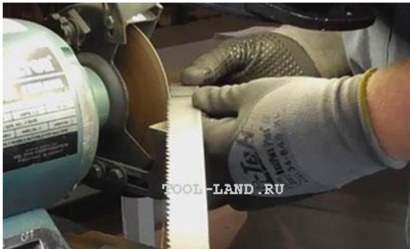
При зачистке с полотна должен быть удален наплыв в зоне сварного шва и придана правильная геометрия межзубовой впадине в месте соединения. Зачищать можно практически любым абразивным инструментом. Главное, чтобы обработанная поверхность получилась ровной и заподлицо с соседними областями.
