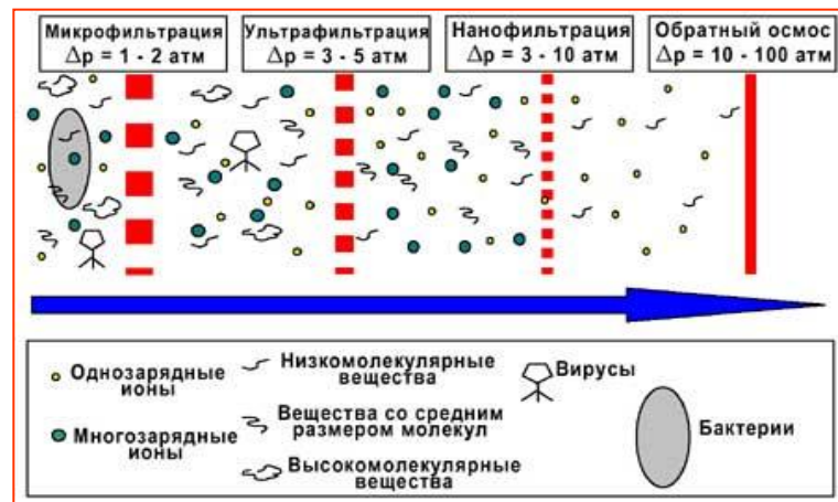
Рис. 2.3.1. Принципиальная схема мембранной технологии: а – процесс фильтрации, б – характеристики мембранных процессов фильтрации
