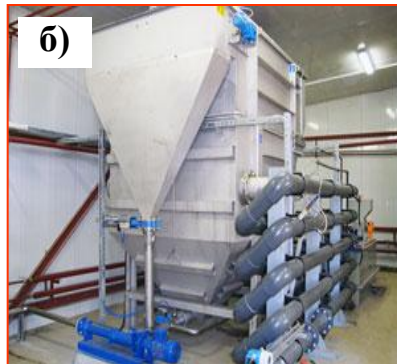
Схема простейшего флотатора (а) и общий вид прямоугольного (б) флотатора
