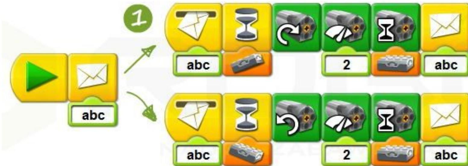
1. Блок с изображением песочных часов приостанавливает выполнение программы до момента выполнения некоторого условия – наклона датчика вверх.
