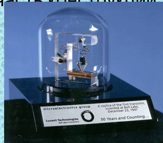
Копия транзистора разработанного в лаборатории Белла 23 декабря 1947 года
