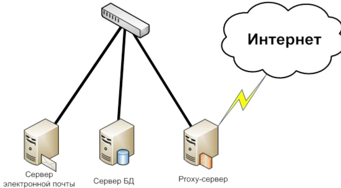
Ядро сети состоит из высокоскоростного маршрутизатора и серверов, связанных между собой линиями со скоростью 1 Гбит/с. Для обеспечения высокой надежности и скорости коммутаторы и серверы соединены с избыточными каналами связи.
