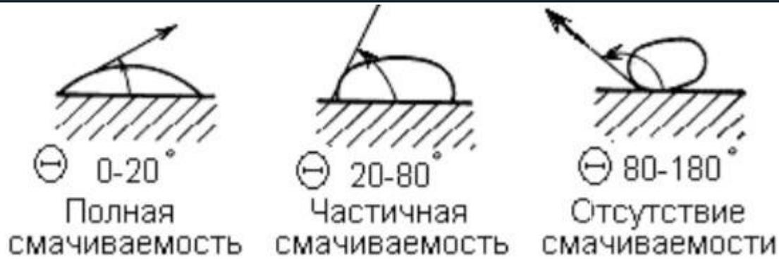
Рисунок 2.1- Определение смачиваемости по крайевому углу смачивания
