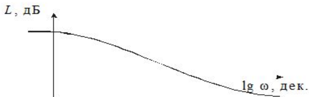
Рисунок 2.9 – Пример логарифмической амплитудной частотной характеристики
