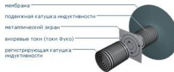
Индуктивный датчик давления
