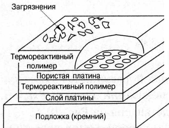
Конструкция емкостного датчика относительной влажности НН-3610
