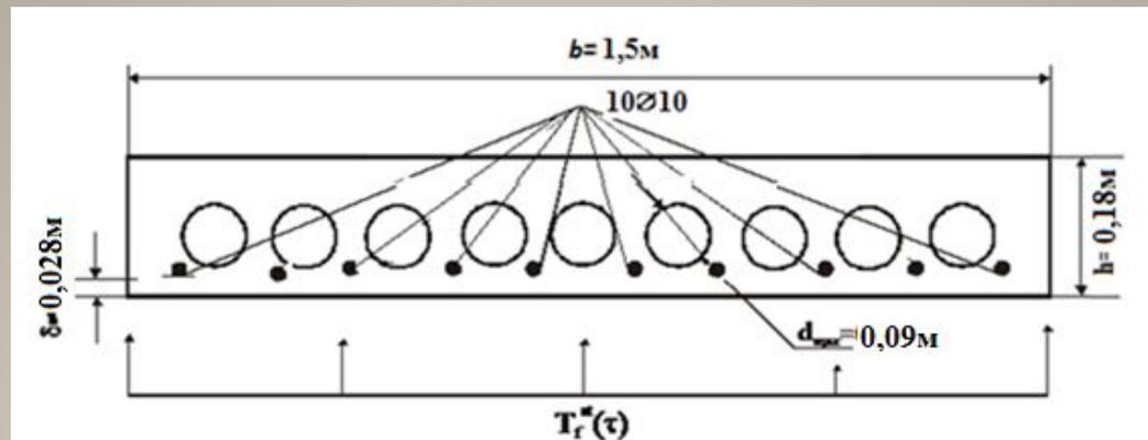
**Дано:** Железобетонная многпустотная плита перекрытия, размерами: пролет  $l=5,9$  м; ширина  $b=1,5$  м; толщина  $h=0,18$  м. Растянутая арматура кл. А-IIIв (А-400в), десять стержней диаметром  $d_s=10$  мм. Бетон тяжёлый, класса В15, толщина защитного слоя бетона до низа растянутой арматуры  $d=0,028$  м. Железобетонная плита свободна опертая. Количество пустот – 9, диаметр каждого отверстия – 0,09 м.
