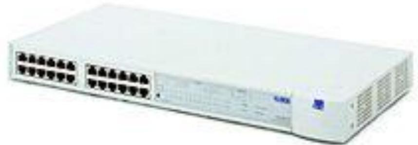
**Концентраторы (HUB или Switch)** - служат для соединения компьютеров в сети. Концентратор может иметь различное количество портов подключения (обычно от 8 до 32).
