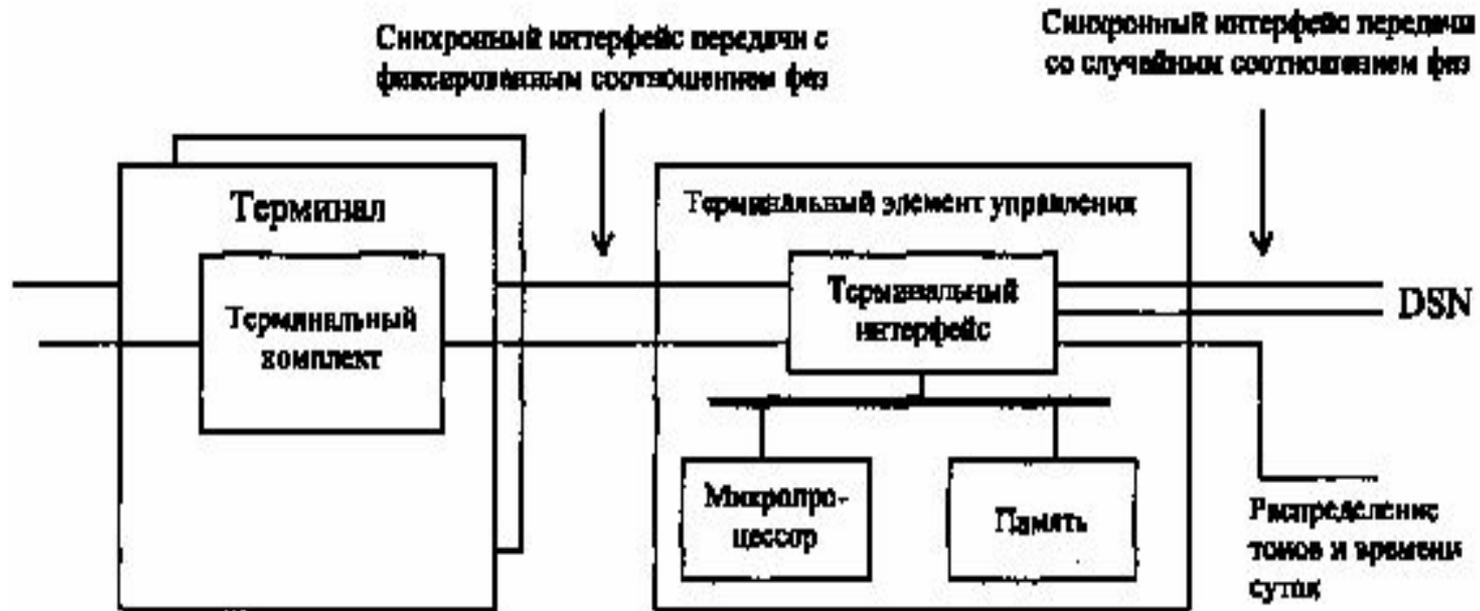
**Блок-схема терминального модуля**
