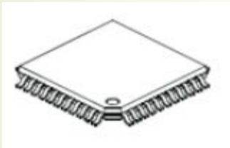
**QFP** (Quad Flat Package) — плоский корпус с четырьмя рядами контактов. Представляет собой квадратный корпус с расположенными по краям контактами. Существуют также другие варианты: **TQFP** (Thin QFP) — с малой высотой корпуса, **LQFP** (Low-profile QFP) и многие другие.
