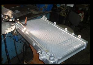
Медницкие работы состоят в ремонте радиаторов, топливных баков, топливо- и маслопроводов. Радиаторы очищают снаружи от грязи, промывают водой и удаляют накипь, применяя один из указанных ранее водных растворов соляной кислоты с добавлением ингибитора. Для определения мест подтекания радиатор погружают в ванну с водой и испытывают, нагнетая в радиатор воздух под давлением 0,25—0,4 кГ/см
