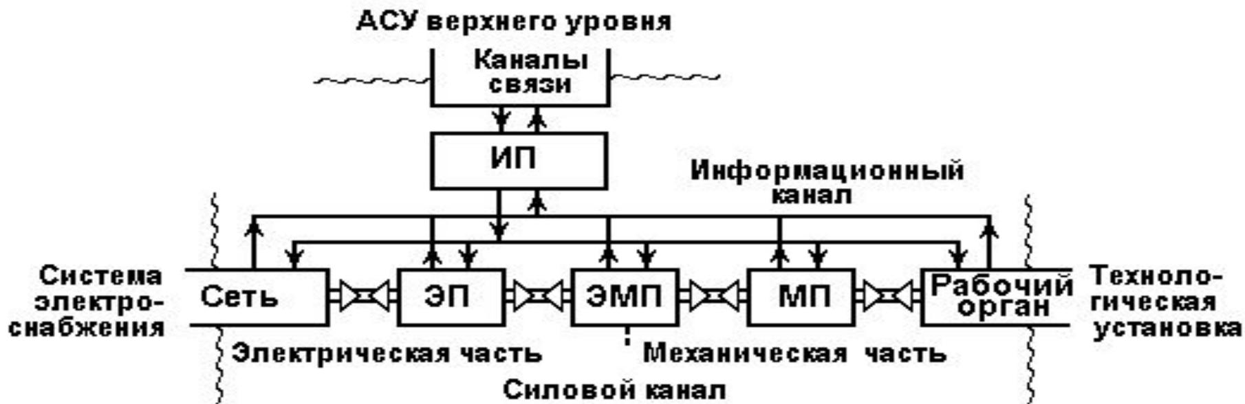
Рис. 1.1. Структурная схема автоматизированного электропривода
