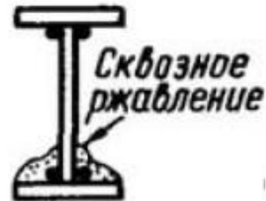
*Щелевая коррозия металлических элементов*
