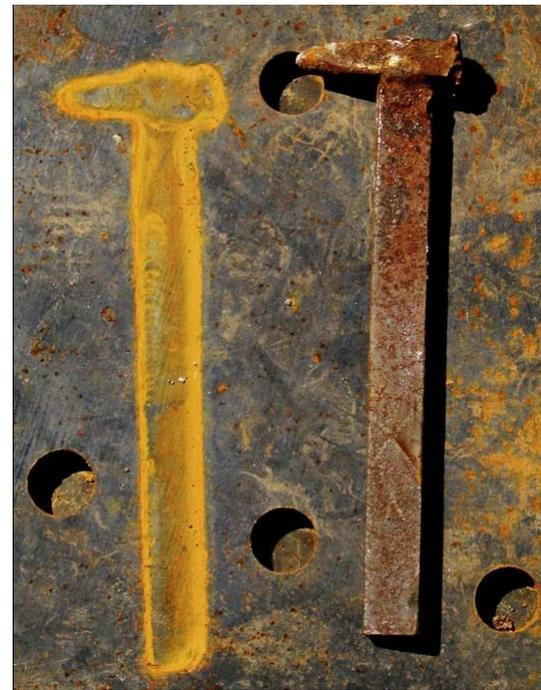
*Поверхностная коррозия металлических элементов*
