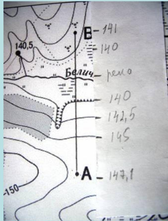
Так как у нас масштаб в 2 раза крупнее, то мы расстояние между двумя соседними горизонтальными будем откладывать по горизонтали в 2 раза больше.
