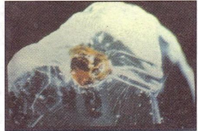
Рис. 13 Включение граната в алмазе
