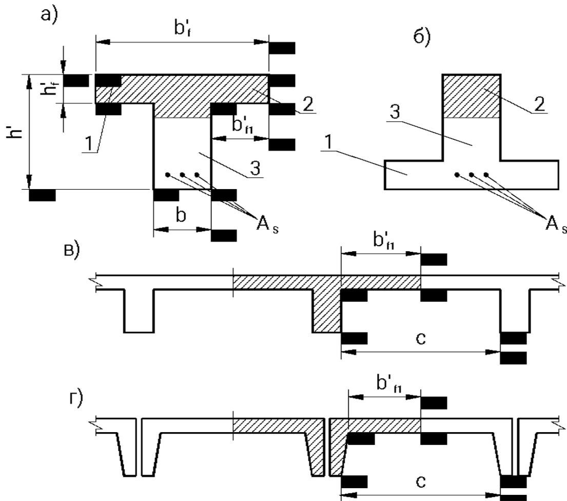
**Тавровые сечения:** а - балка с полкой в сжатой зоне, б – то же в растянутой зоне, в – тавровое сечение в составе монолитного перекрытия, г – то же в составе сборного перекрытия, 1 – полка, 2 – сжатая зона, 3 - ребро.
