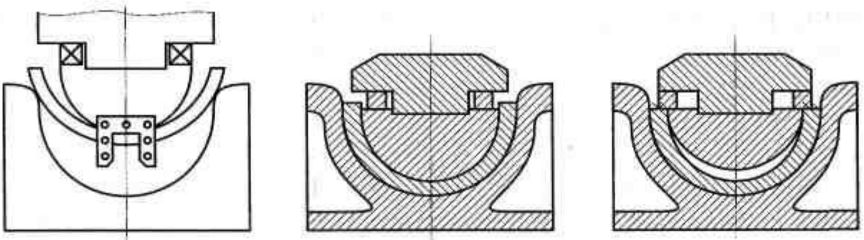
Технологический процесс штамповки полуобечаек на гидравлическом прессе:
