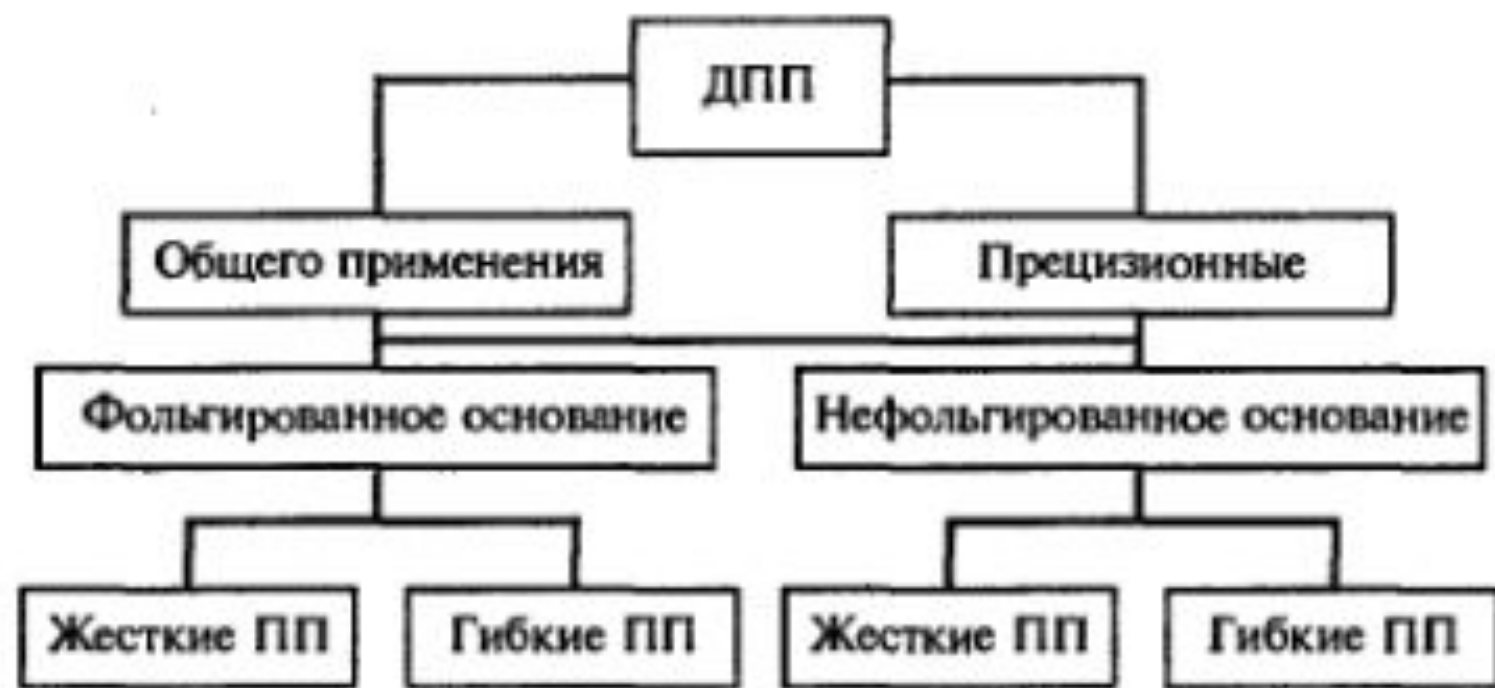
Классификация ДПП, в зависимости от материала основания
