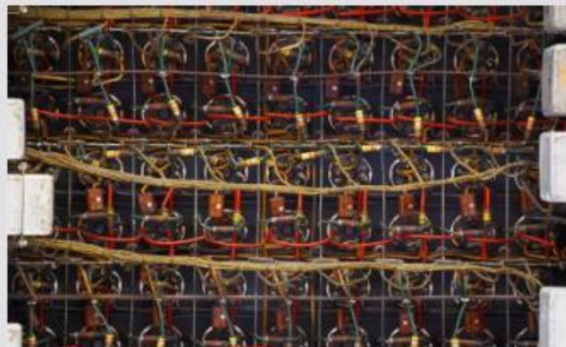
Монтаж электронных ламп на компьютерах первого поколения
