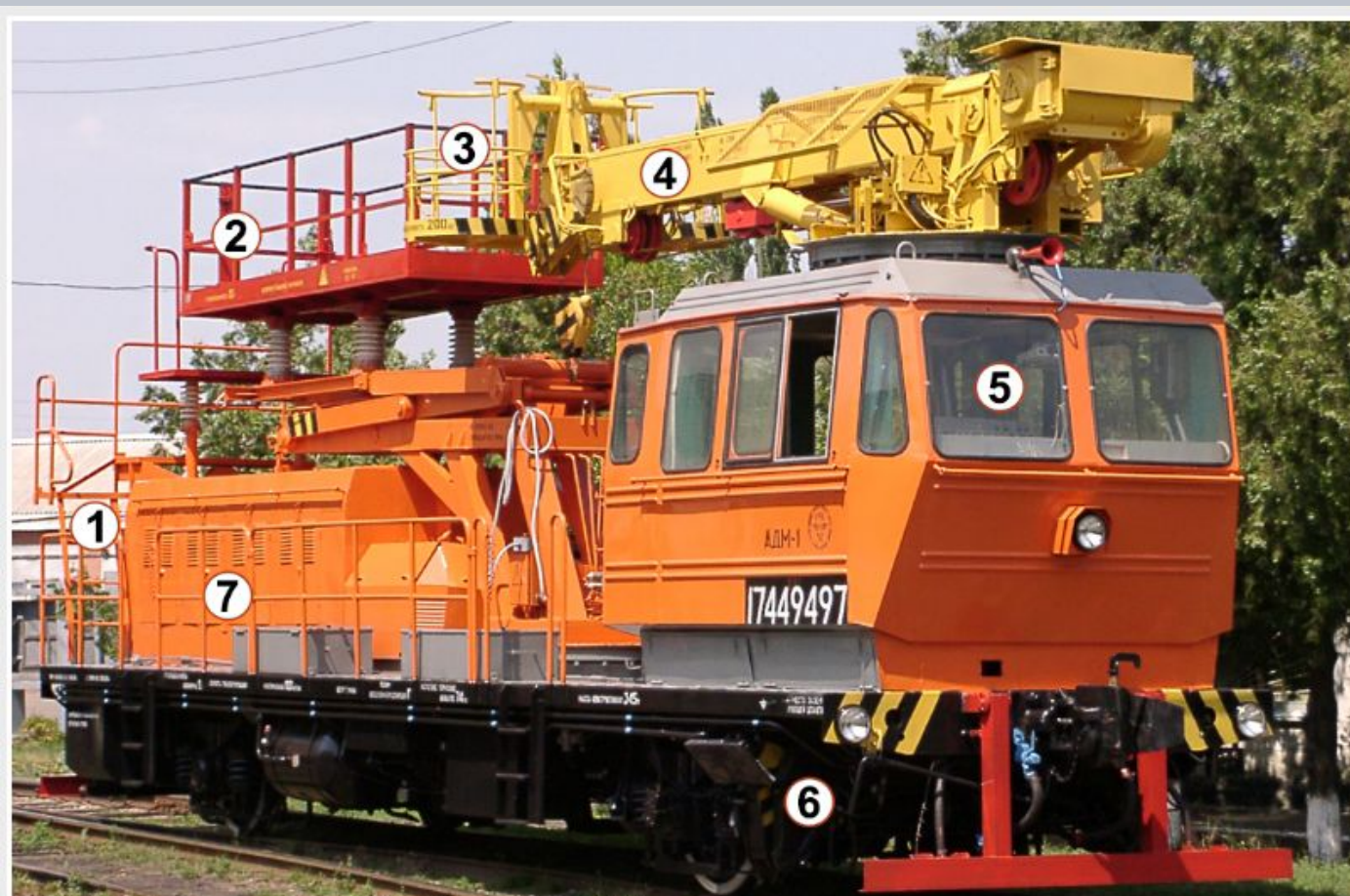
Автомотриса дизельная монтажная АДМ-1: 1 - переходная площадка; 2 - рабочая площадка; 3 - съемная люлька; 4 - грузоподъемный кран; 5 - кабина; 6 - выносная опора (аутригер); 7 - дизель
