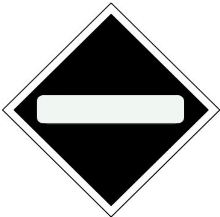
При появлении на сигнальном указателе **мигающей светящейся полосы прозрачно-белого цвета** машинист **обязан проследовать ограждаемый воздушный промежуток с опущенными токоприемниками.** Нормально сигнальные полосы указателей не горят и в этом положении сигнального значения не имеют.
