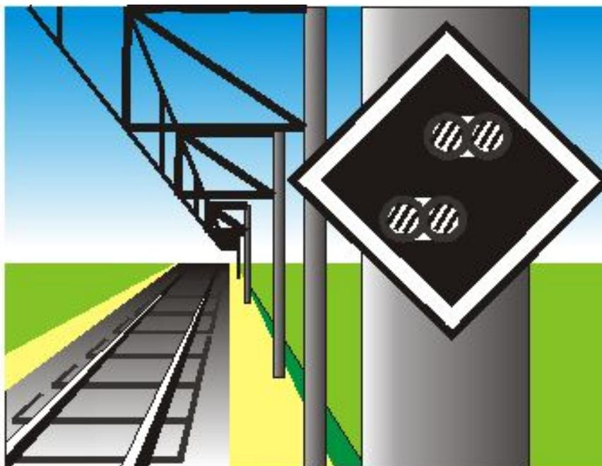
Постоянный сигнальный знак с отражателями **«Поднять токоприемник на электровозе»** устанавливается за воздушным промежутком в направлении движения.
