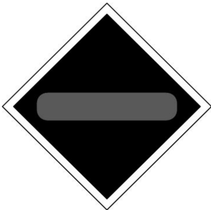
На электрифицированных участках **постоянного тока** перед воздушными промежутками, где при внезапном снятии напряжения в одной из секций контактной сети не допускается проследование ЭПС с поднятым токоприемником, **применяются сигнальные световые указатели «Опустить токоприемник»**, которые помещаются на опорах контактной
