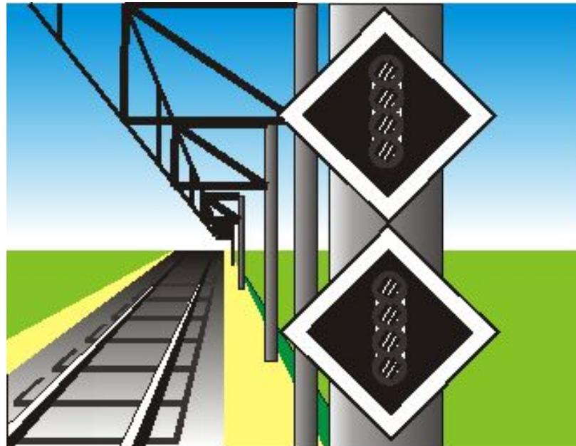
Опоры контактной сети, ограничивающие воздушный промежуток, имеют отличительный знак: **чередующиеся 4 черные полосы и 3 белые**. Первая опора, кроме того, дополнительно обозначается вертикальной, черной полосой. Эти знаки наносятся непосредственно на опору или на щиты, закрепляемые на опоре.
