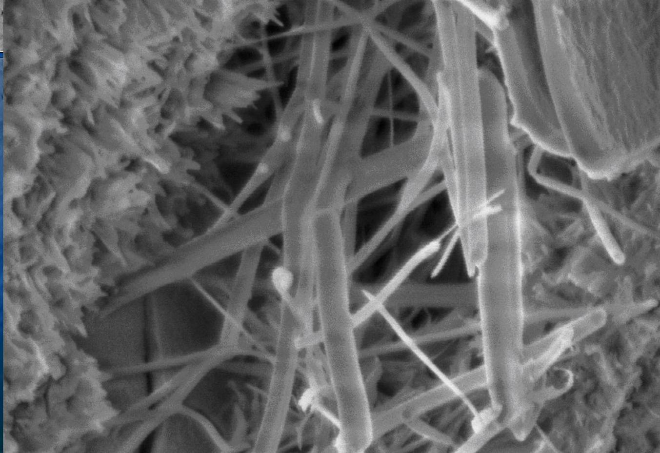
Одним из способов повышения прочности бетонов считается модифицирование базальтовыми волокнами, однако, базальтовое волокно не обладает стойкостью к щелочной среде. В целях решения этой задачи была выдвинута гипотеза о целесообразности введения дисперсии углеродных нанотрубок в смесь. Дисперсия УНТ, действительно, оказала влияние на морфологию новообразований в областях контакта волокон с цементным камнем. Вокруг волокна образуются уплотненные структуры, предотвращающие выщелачивание.
