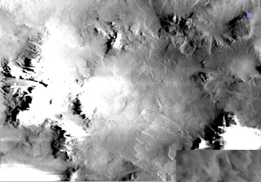
■ Наличие этих игольчатых наростов может свидетельствовать об увеличении прочностных характеристик материала, так как они выполняют армирующую роль в структуре бетона и дискретное наноструктурирование цементных систем.
