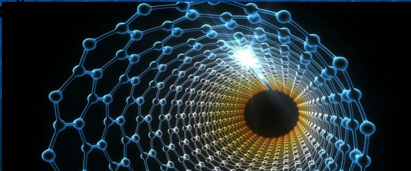
Керамический композит на основе  $Al_2O_3$  с 5–10% УНТ оказался в 5 раз более устойчивым к растрескиванию и в  $10^{13}$  раз более электропроводным, чем обычная керамика.
